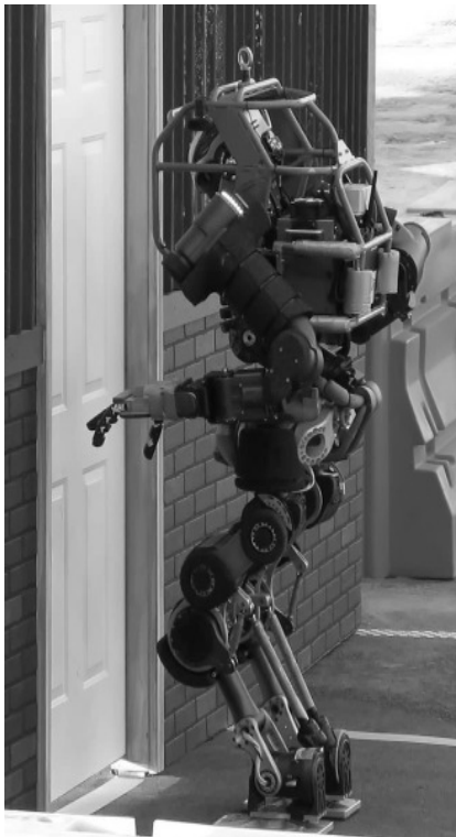
Figura 2.2: A sinistra, il robot umanoide WalkMan, realizzato dall'Istituto Italiano di Tecnologia e dal Centro E. Piaggio della Università di Pisa, mentre apre una porta durante una prova della DARPA Robotics Challenge del 2015. A destra: modello 2D semplificato del robot.
